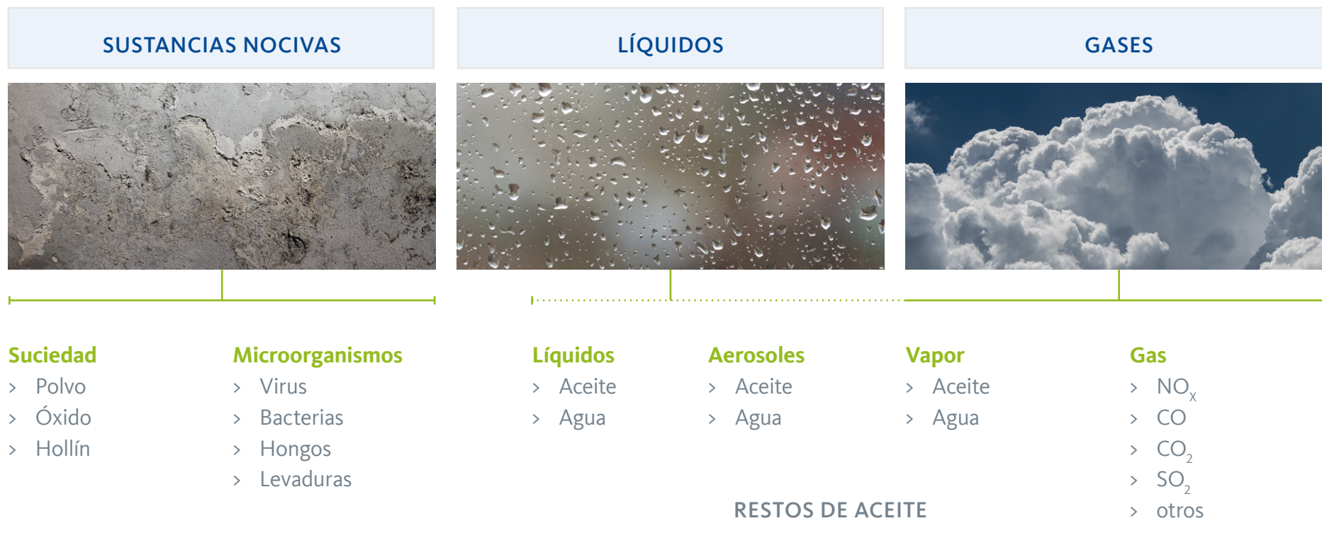
Fig. 2: Posibles impurezas en el aire comprimido.
